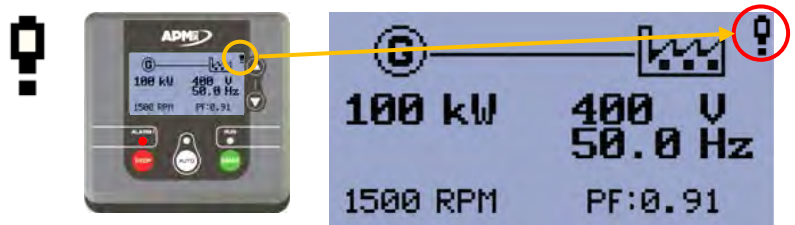
figura 13 - aparición de una alarma
