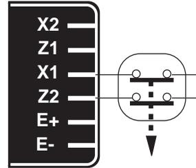
La desexcitación se obtiene interrumpiendo la alimentación del regulador (1 hilo en cada bobinado auxiliar) calibre de los contactos 16 A - 250V alt.
