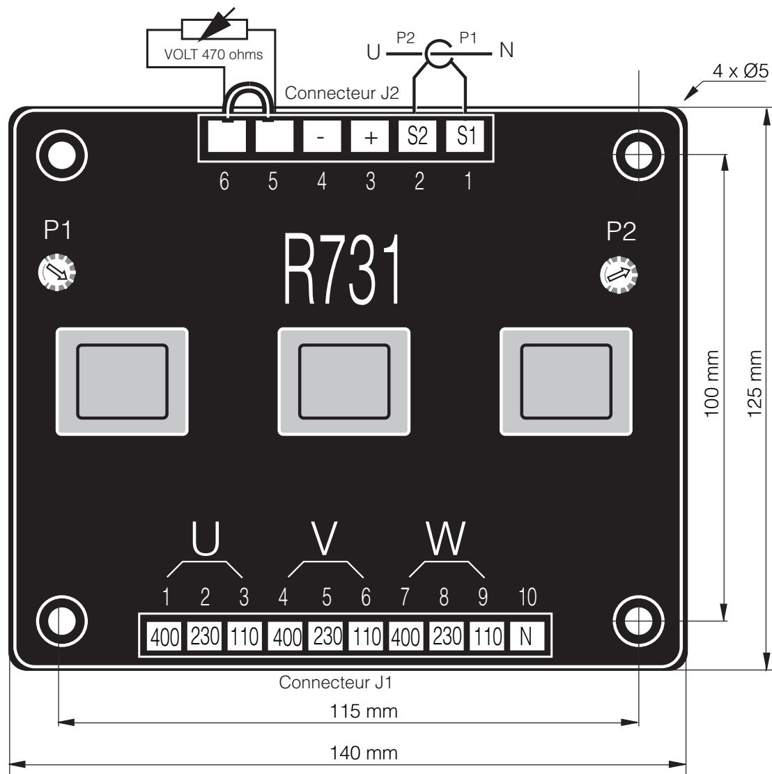
P1 : Potentiomètre tension / Voltage potentiometer
