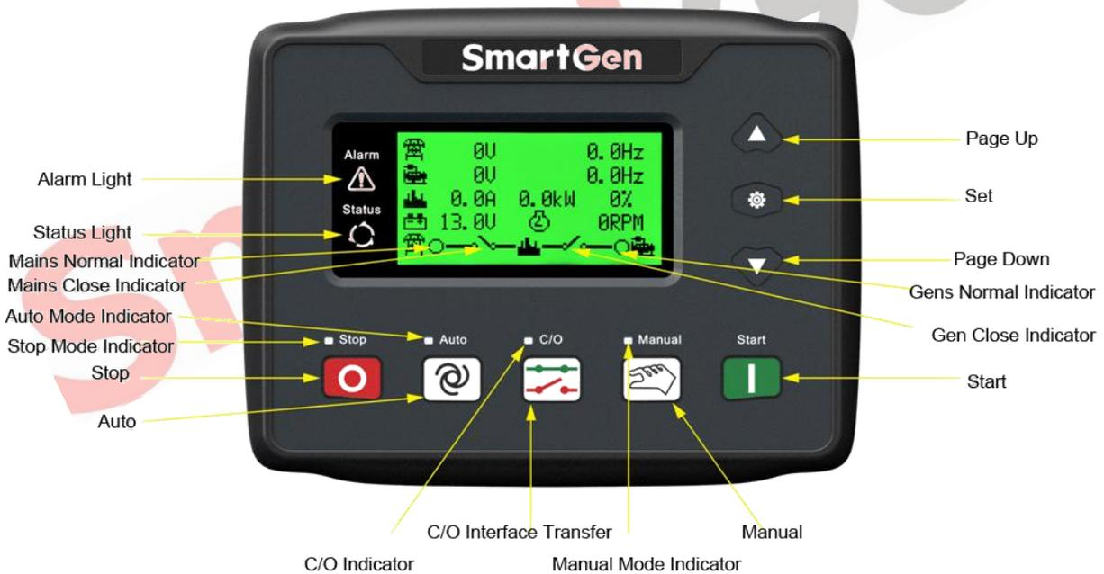
Fig.2 - HGM4020N/HGM4020NC/HGM4020CAN Front Panel Indication
